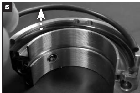
5 Rimuovere le due metà usate dell'O-ring della faccia rotante.
