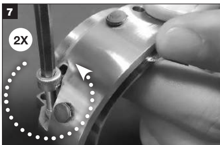
7 Rimuovere le viti a testa cava usate dalle metà del supporto.
