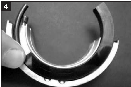
4 Rimuovere le due metà usate della rotante spingendo sull'estremità della faccia e facendole scorrere fuori.
